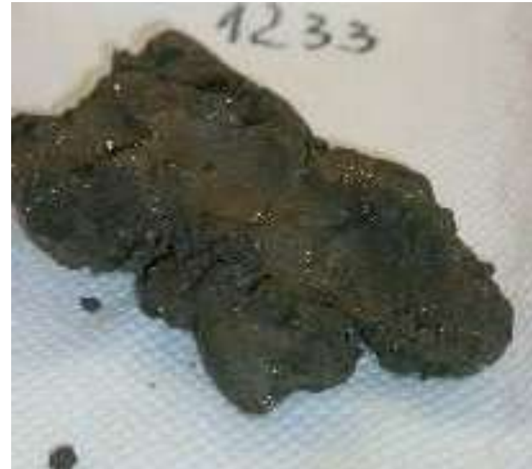
grunt zanieczyszczony rtęcią źródło: IETU
