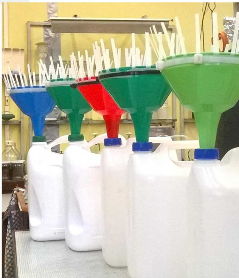
Kolektory na opad
