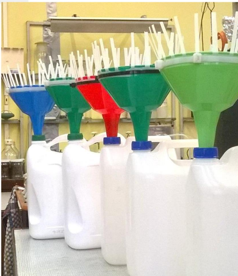
Kolektory na opad
