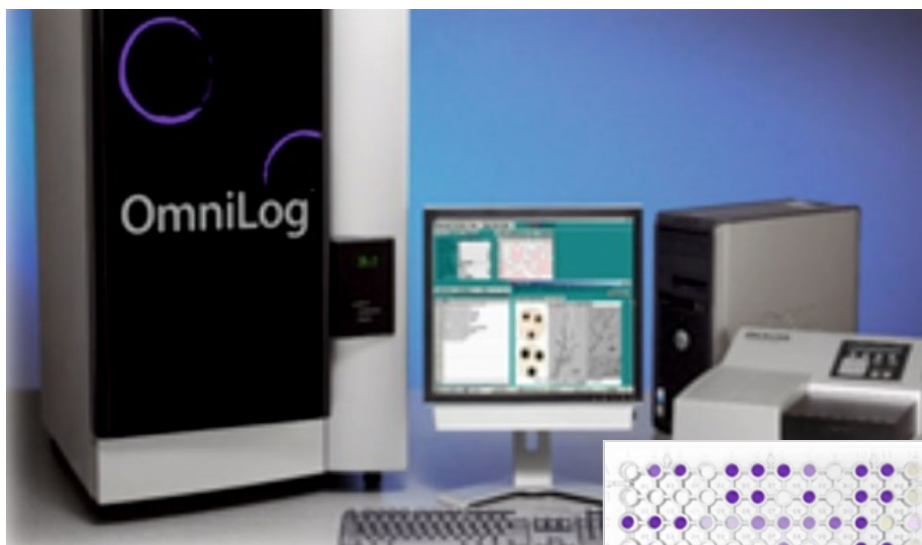
Fot. System BIOLOG ® do identyfikacji wielooporności bakterii i wyznaczenia wartości MIC (Minimalne Stężenie Inhibicji) dla kilkudziesięciu antybiotyków z różnych grup chemicznych
