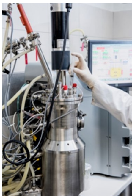
Fot. Bioreaktor, w którym przeprowadzono biodegradację w skali półtechnicznej i monitorowano parametry procesu
