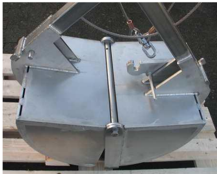
Próbnik osadu dennego typu Van Veen, KC Denmark
